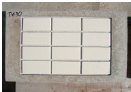
写真-3 貼替え前の試験体
