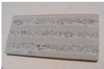
写真-18 温冷繰り返しを行っていない引き抜き試験後のタイル
