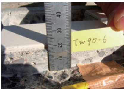
写真-6 タイル裏から15mmはつったもの、手前は埋め込みの熱電対
