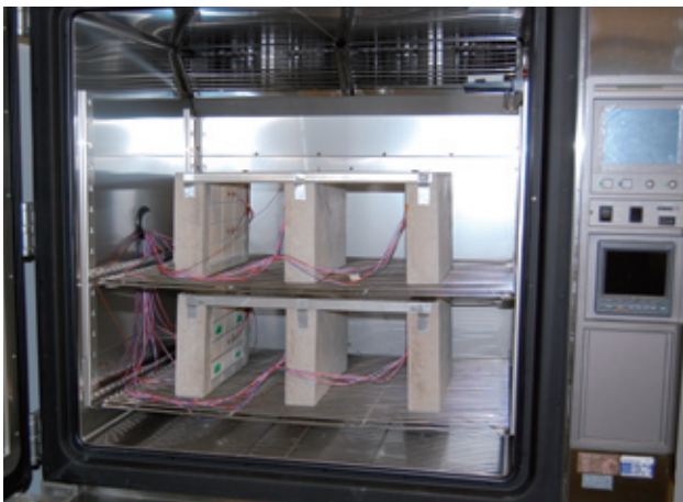
写真 -14 温冷繰り返し試験の状況
