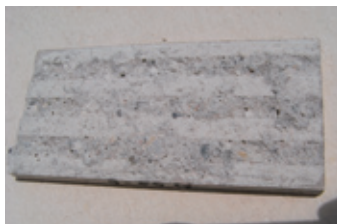
写真-19 90サイクルを負荷した引き抜き試験後のタイル
