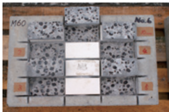
写真-16 引き抜き試験後の状況
