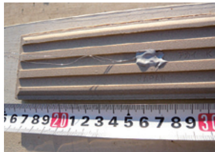
①：タイル裏面にステンレス鋼線を接着した状況
